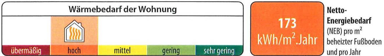
Dieser Bedarf ist die Wärmezufuhr, die von der Heizung bereitgestellt werden muss, um die Innentemperatur der Wohnung konstant zu halten. Er hängt ab von den Verlusten durch die Wände entsprechend ihrer Wärmedämmung, den Verlusten durch mangelnde Luftdichtigkeit, den Verlusten durch die Belüftung, aber auch von den Solarbeiträgen und den internen Beiträgen.
